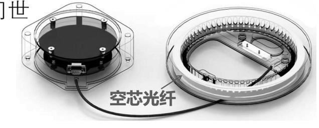
图为空芯光纤陀螺系统，左侧为光电系统，右侧为光纤环圈。 研究团队供图
